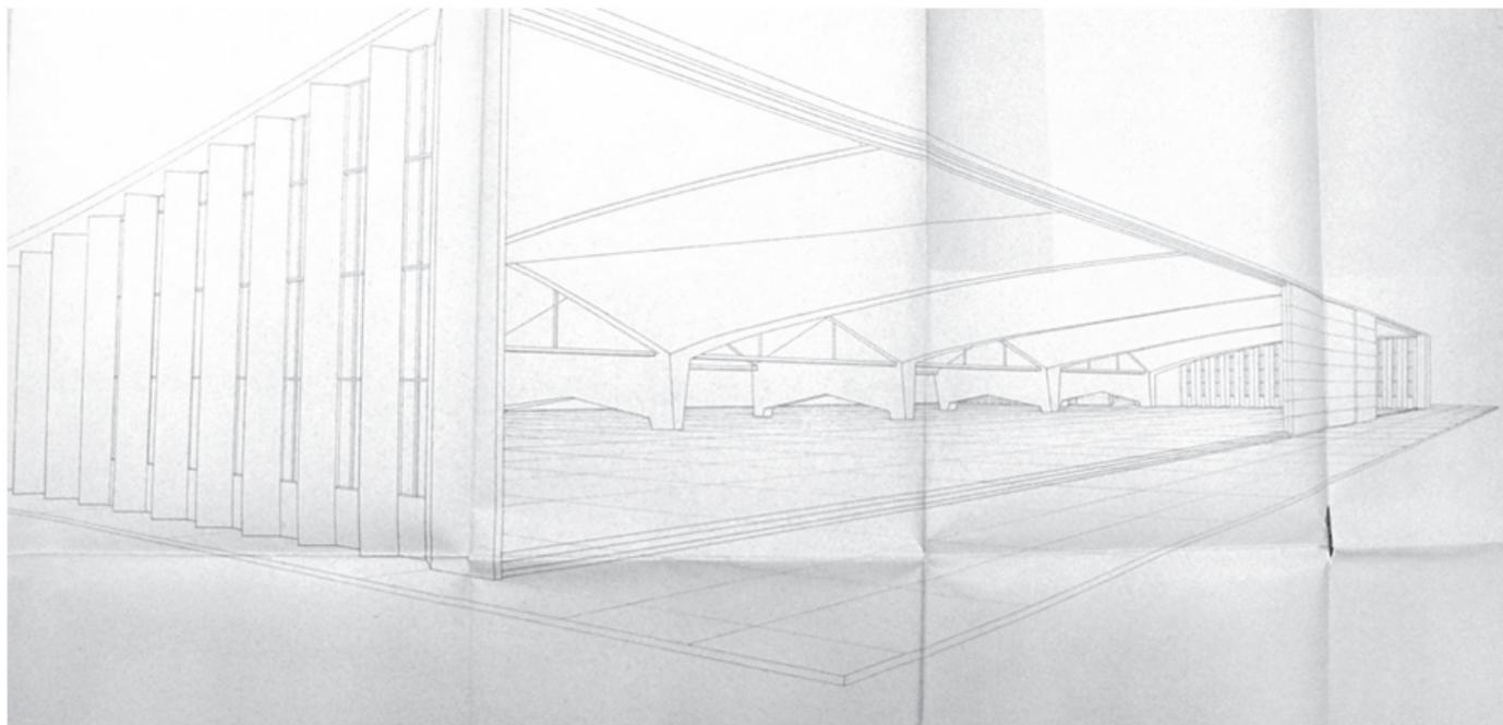
Fig. 1: Unrealised project (1932) by Laffaille for a « Caquot » type aircraft hangar with thin concrete shells (Fonds Laffaille, file 206 ifa 59/2 –SIAF/cité de l’architecture et du patrimoine/Archives d’architecture du XXe siècle).
