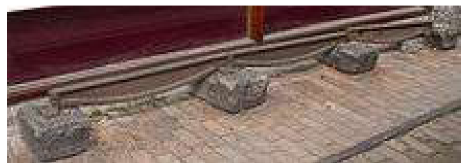
13 Gusseiserne Schiene von William Jessop, 91 cm lang, 1789
