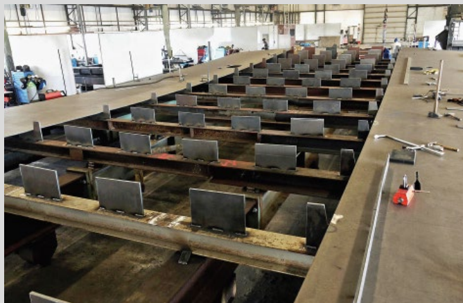
Bild 1. Das Untergestell für die 21,70 m lange Drehbrücke der Inselstadt Malchow steht bei der Kiellegung in den Werkshallen von SCHORISCH Magis in Karstädt auf dem Kopf (Quelle: D. Schmaglowski/Inselstadt Malchow)
